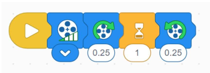
Iniciamos la potencia del motor al mínimo, levantamos el techo y puerta,
